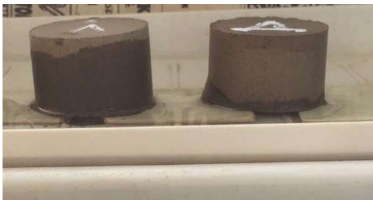
Рисунок 1 - Капиллярное всасывание у образцов, обработанных САД и АКЛ
