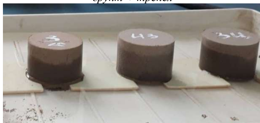
Рисунок 4 – Испытание на капиллярное всасывание грунт + зола ВКЗ, грунт + известь, грунт + цемент
