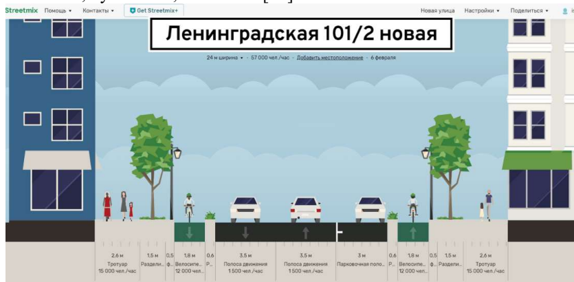
Позже, с помощью сайта Streemix, были выполнены разрезы улиц (см. рис. 3), упрощающие понимание необходимости конкретных изменений на сложных для реконструкции участках. Изменения основывались на СП 42.13330.2016 –Градостроительство, пункт 11.4, табл. 11.2, пункт 11.7, табл. 11.6 [12].
