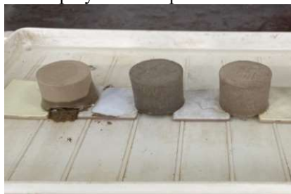
Рисунок 3 – Испытание на капиллярное всасывание грунта, грунт + МК, грунт + трепел
