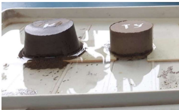
Рисунок 2 - Капиллярное всасывание у образцов без добавки и с добавлением ССК
