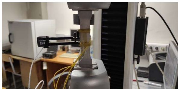
Рисунок 2 – Тарировка тензометрического датчика на испытательной машине Instron
