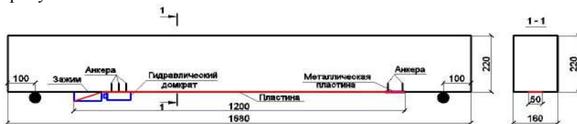
Рисунок 1 – Схема усиления преднапряженными ПКМ железобетонных лабораторных образцов
