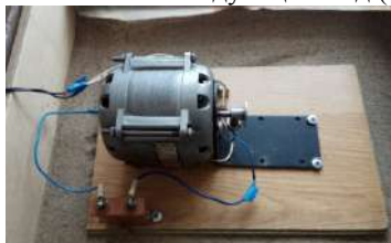
Рисунок 1 - Общий вид установки (модель фундамента и вибратор)
