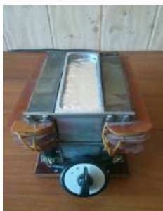
Рисунок 3 – Физическая модель МГД - перемешивателя жидкой сердцевины
