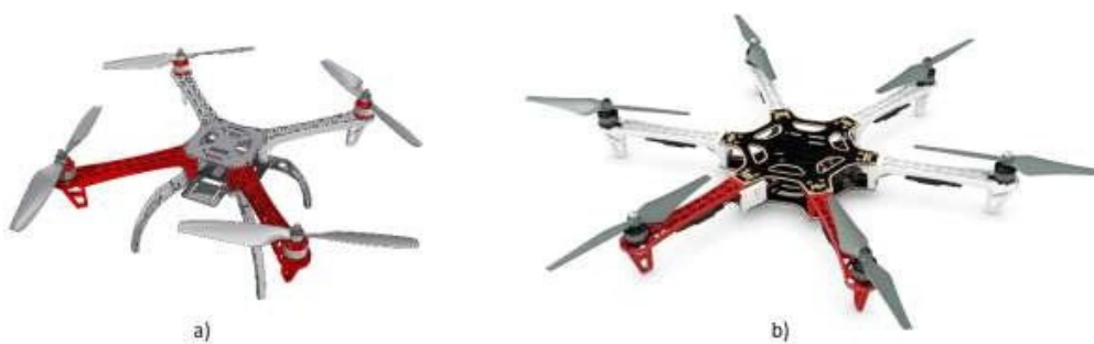
Рис. 2. Конструкция квадрокоптера (a) и гексакоптера (b)
