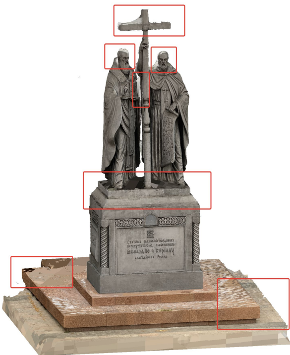
Результат построения 3D-модели по снимкам. Красным - артефакты построения, вызванные нехваткой снимков сверху от памятника
