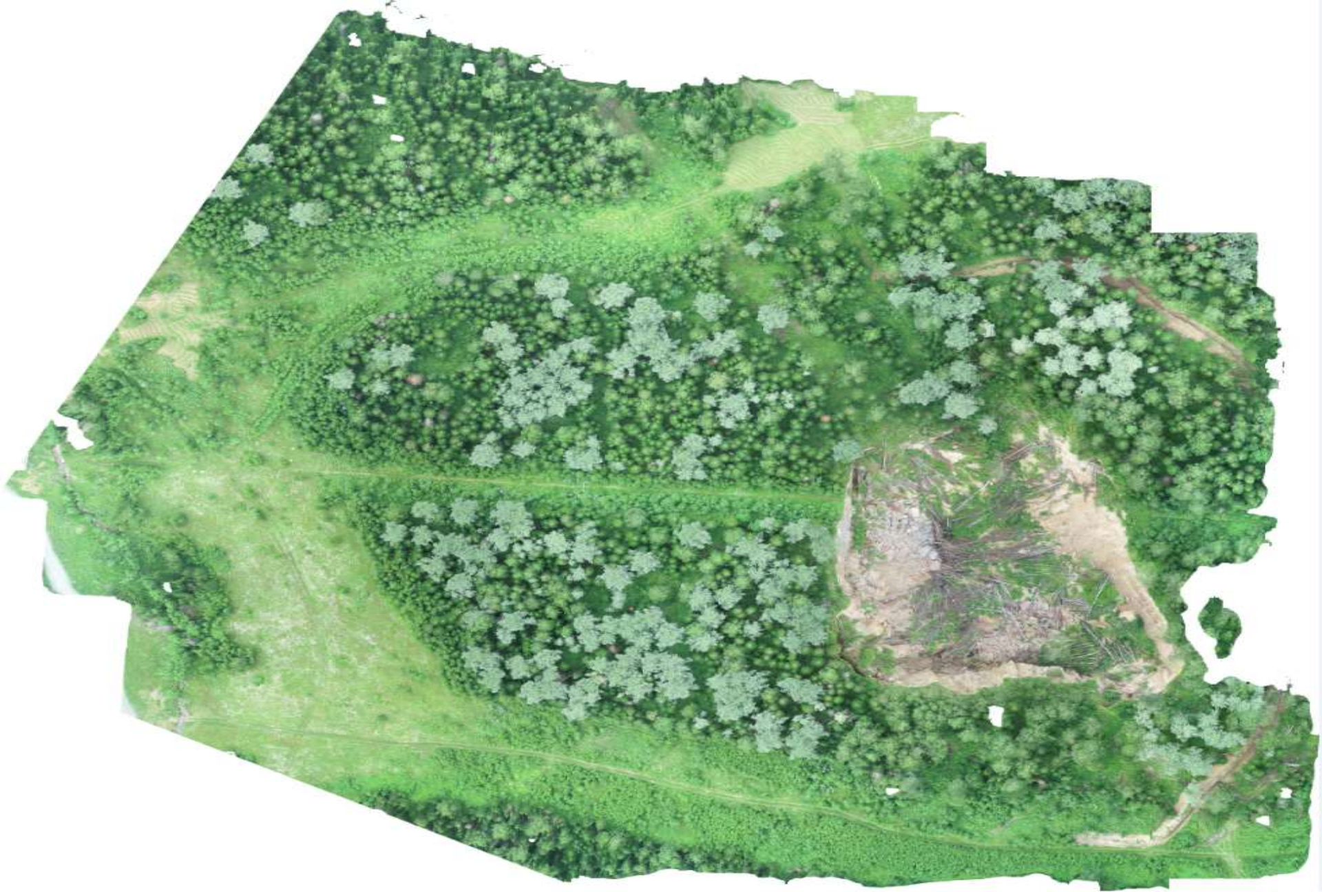
Ортофотоплан полученный с помощью аэрофотосъемки
