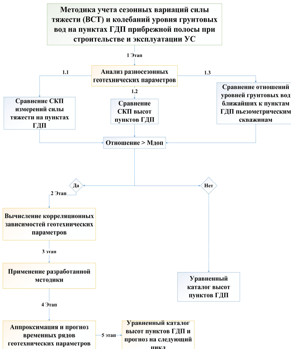
Рисунок 3 – Разработанный алгоритм применения методики учета геотехнических параметров \Phi ( \Delta G_P , \Delta F ) и T ( \Delta H , \Delta G_P , \Delta F ) на пунктах ГДП
